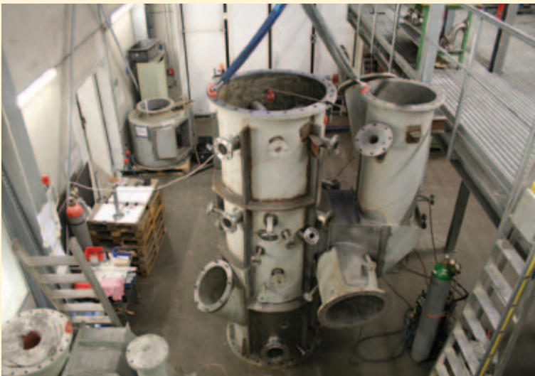
Abb. 4 Im Kalzinator werden \text{CO}_2 und Kalk wieder getrennt.
