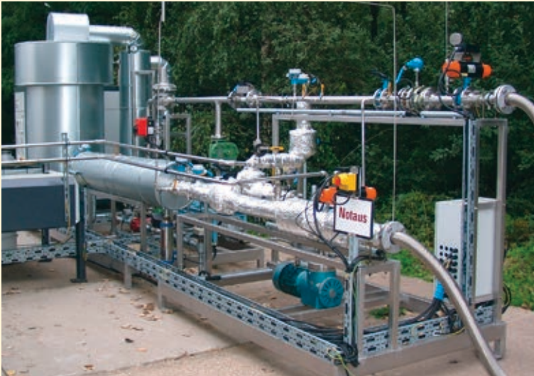
Abb. 3 Das Forschungsteam erprobte sowohl die katalytische Abscheidung an aktiviertem Aluminiumoxid (Kat-Ox-Verfahren) als auch die adsorptive Reinigung durch Aktivkohle mit anschließender Regeneration (Aktivkohle-Verfahren).
