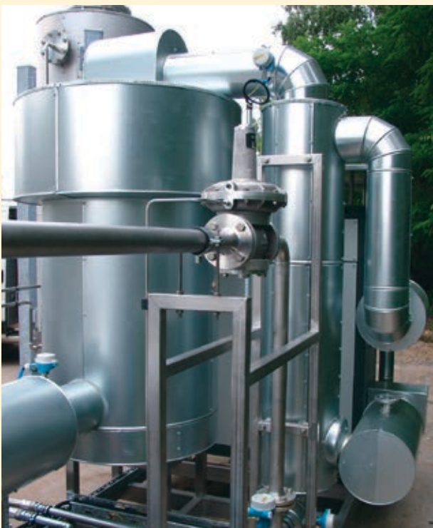
Abb. 4 Die beiden Materialien Aluminiumoxid und Aktivkohle untersuchte das Forschungsteam jeweils in einem isolierten Festbettreaktor mit Deponiegas.
