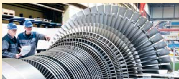
Abb. 3 Eine einhäusige Industrie-Dampfturbine zur Stromerzeugung mit einer Leistung von 80 MW
